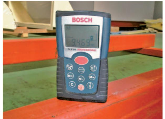
レーザースケールにより天井高の測定
